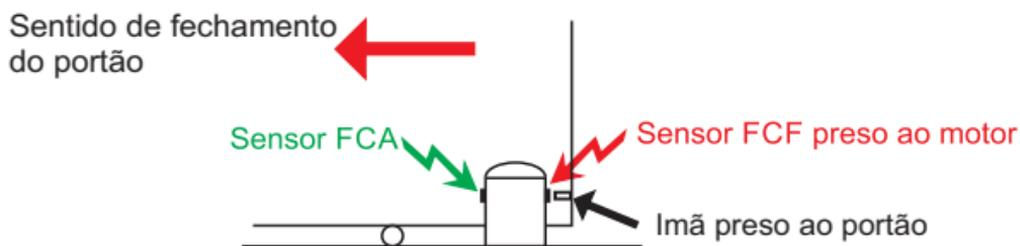
Observe que a ligação dos sensores deve ser respeitada conforme a disposição dos sensores em relação a direção de fechamento do portão.
