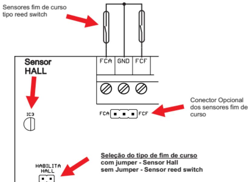
A função destes sensores é detectar quando o portão chega ao final de seu percurso de aberto ou fechado. Basicamente são compostos em duas partes: o sensor eletrônico que vai ligado a placa conforme desenho acima e é fixado no corpo do motor, e os ímãs que são colocados um em cada extremidade do portão conforme desenho abaixo.
